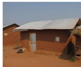
Maison en adobe avec toiture en tôle
